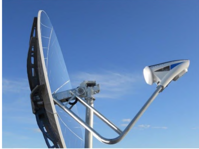
Şekil 2.10 : Stirling motoru kullanılan bir parabolik çanak (Url 5).
