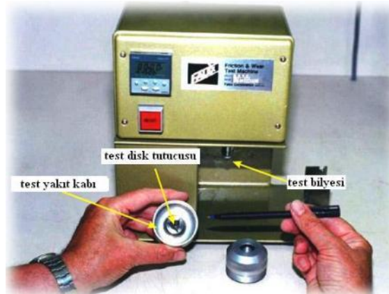
ekil 4. BOTD cihazının a) çalı ma prensibi b) genel görünümü [20].
