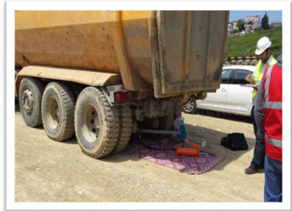
Resim 2.7. Plaka yükleme testi
