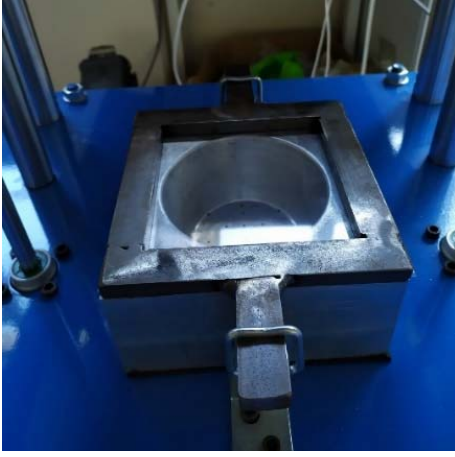
Şekil 2. Tutucu, PVC film ve konik dişi kalıp
