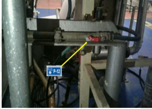
Resim 4.40. Tutkal ünitesi alt tava basınçlı hava enerjisi kesme noktası
