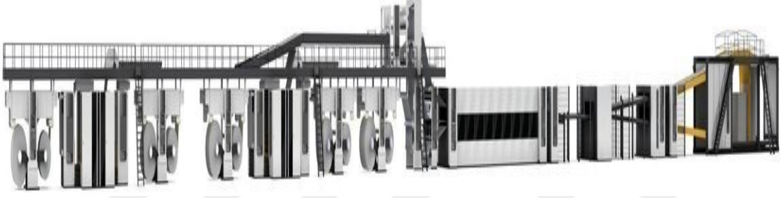
Resim 3.1. Oluklu mukavva üretim makinesi
