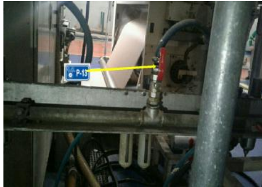
Resim 4.41. Tutkal ünitesi alt tava geri dönüş basınçlı hava enerjisi kesme noktası
