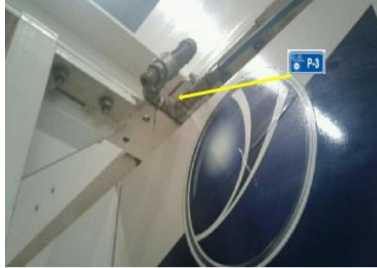
Resim 4.12. Ekleyici (birleştirici) ana basınçlı hava enerjisi kesme noktası
