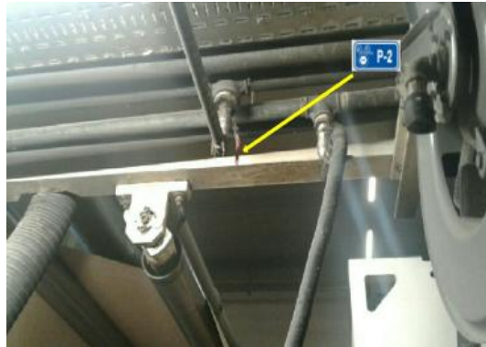
Resim 4.31. Oluklama tutkal pompası basınçlı hava enerjisi kesme noktası
