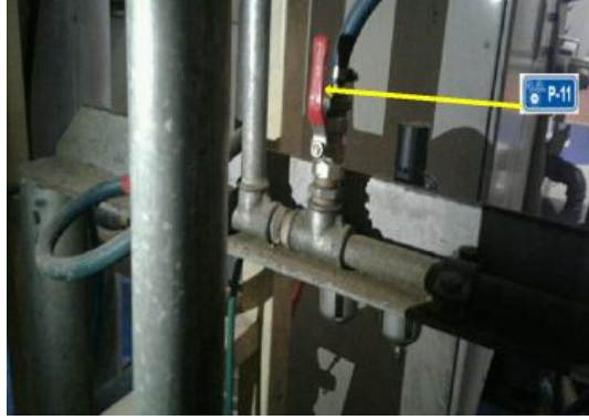
Resim 4.39. Tutkal ünitesi üst tava geri dönüş basınçlı hava enerjisi kesme noktası
