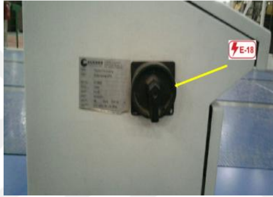
Resim 4.62. Otomatik istifleyici ana elektrik enerjisi kesme noktası
