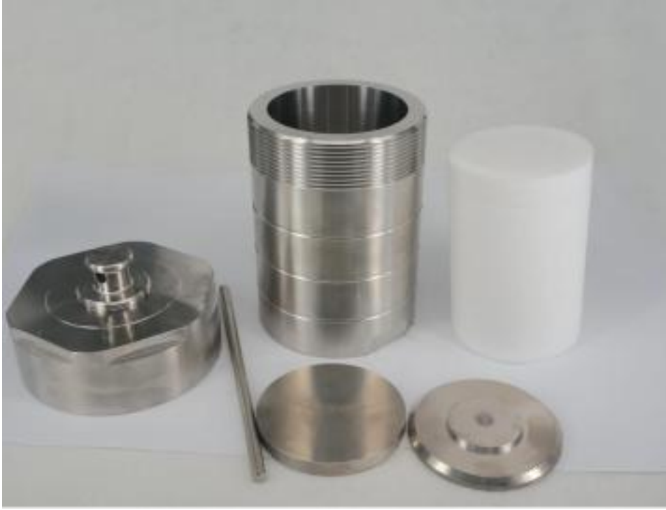
Şekil 2.18: Hidrotermal sentez için teflon otoklav ekipmanları
