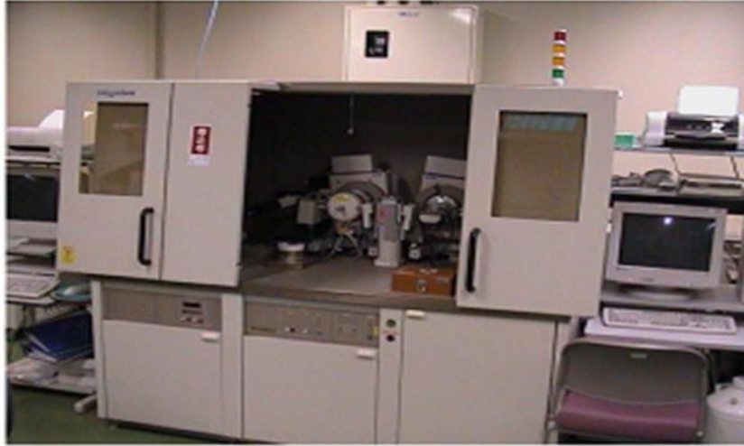
Şekil 2.31: X-ışını difraktometresinin iç kısmı [114].
