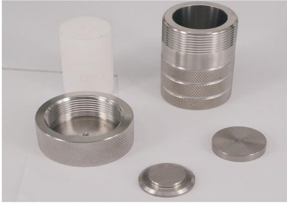
Şekil 2.17: 15 ml PTFE hidrotermal sentez otoklav reaktörü
