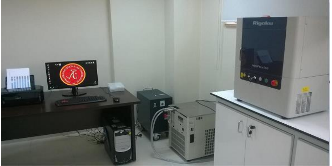
Şekil 2.32: Xrd rigaku miniflex 600 x-ışını difraktometresi cihazı [115].
