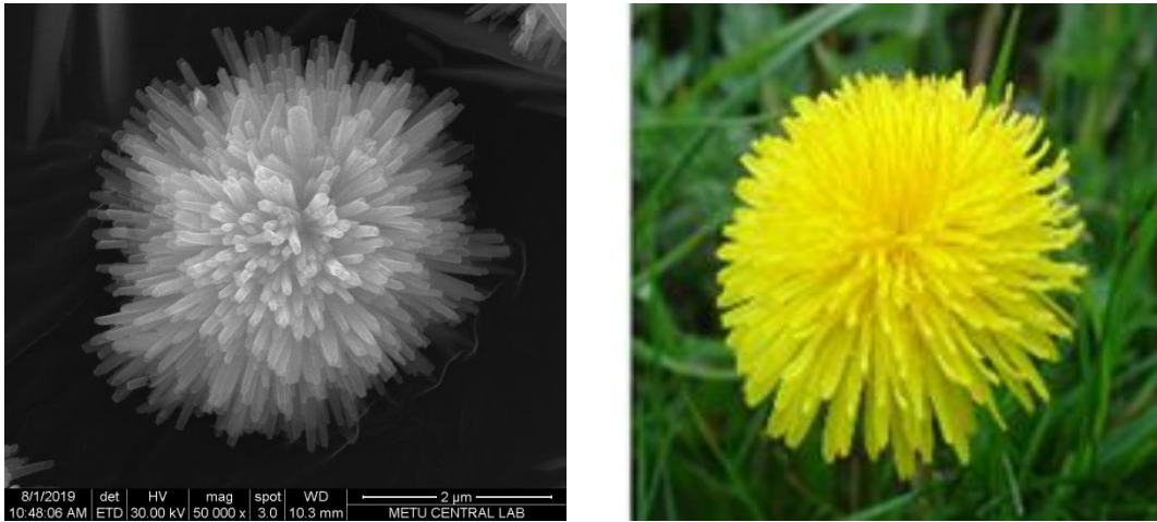
Şekil 3.2: 1 saat 150 °C 'de hazırlanan karahindiba görünümlü Bi 2 S 3 yapılarının SEM görüntüsü.
