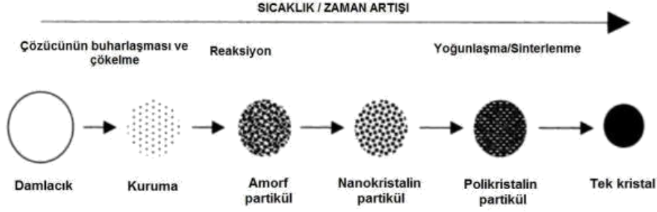
Şekil 2.13: Sprey piroliz sürecinin şematik gösterimi [74, 75].
