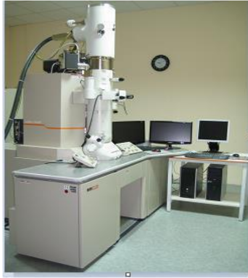
Şekil 2.37: Yüksek çözünürlüklü geçirmeli elektron mikroskobu (Jeol 2100F 200kV HR-TEM) [119].
