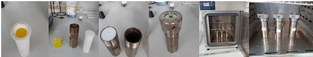
Şekil 3.3: Bi 2 S 3 yapılarının teflon otklavda üretim aşamaları.
