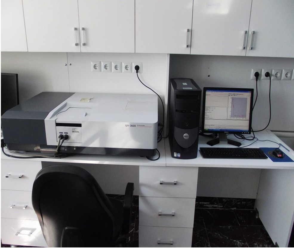
Şekil 3.2. Katkısız ZnO ve CdO-ZnO/p-Si diyotlarının U-V ölçümleri için kullanılan UV-VIS spektrofotometre cihazı
