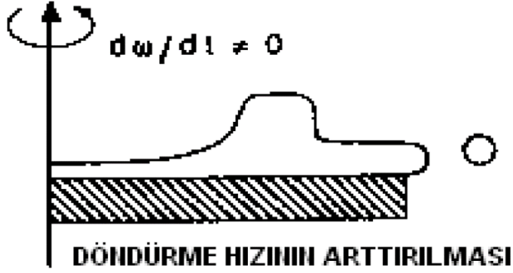
Şekil 2.25. Spin kaplamada çözeltinin düşük hızlarda döndürülmesi
