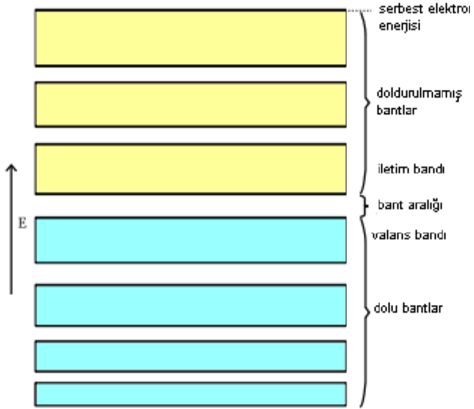
Şekil 2.3. Yarıiletkenlerin band yapısı
