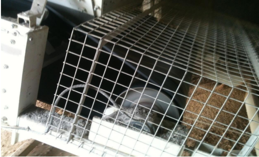
Şekil 5.6 : Agrega taşıma bantı hareketli kısımlarına erişimi kısıtlamak için alınan önlem.
