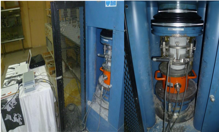
Şekil 1. Elastisite modül belirlemede deney düzenegi
