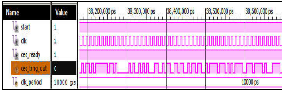
Şekil 2. FPGA üzerinde kaos tabanlı tasarlanan GRSÜ Xilinx ISE Simülatör sonucu.
